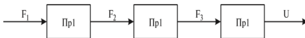
Рис. 1.1. Функциональная схема датчика: Пр1, Пр2, Пр3 – преобразователи; F_1 – входная физическая величина; F_2, F_3 – промежуточные физические величины; U – выходной электрический сигнал
